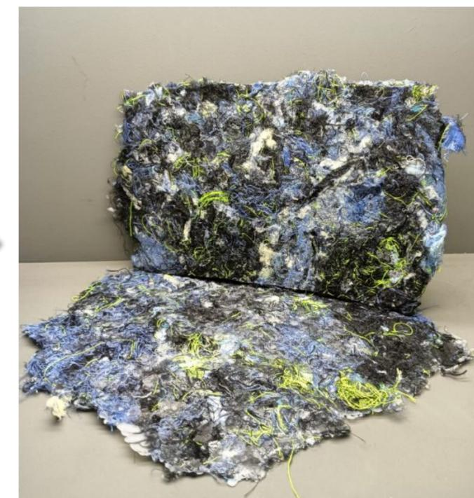
Mediante **pressotermoformatura**, sfruttando le proprietà termoplastiche del materiale tessile e del binder aggiunto.
