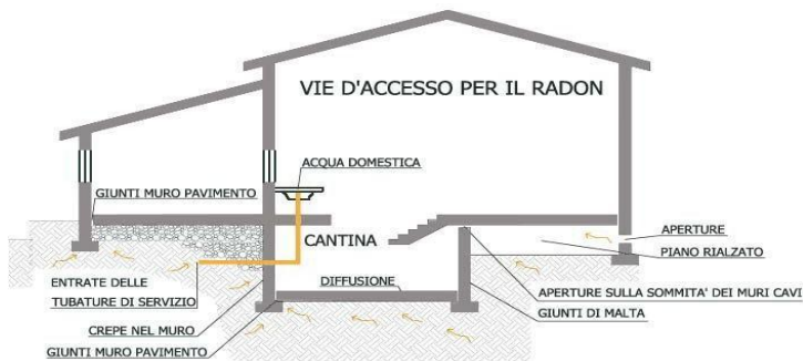
Figura 8: vie d'accesso per il radon
