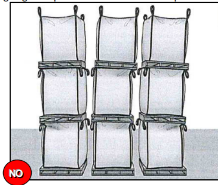
Fig 1: modalità di stoccaggio non accettabile
