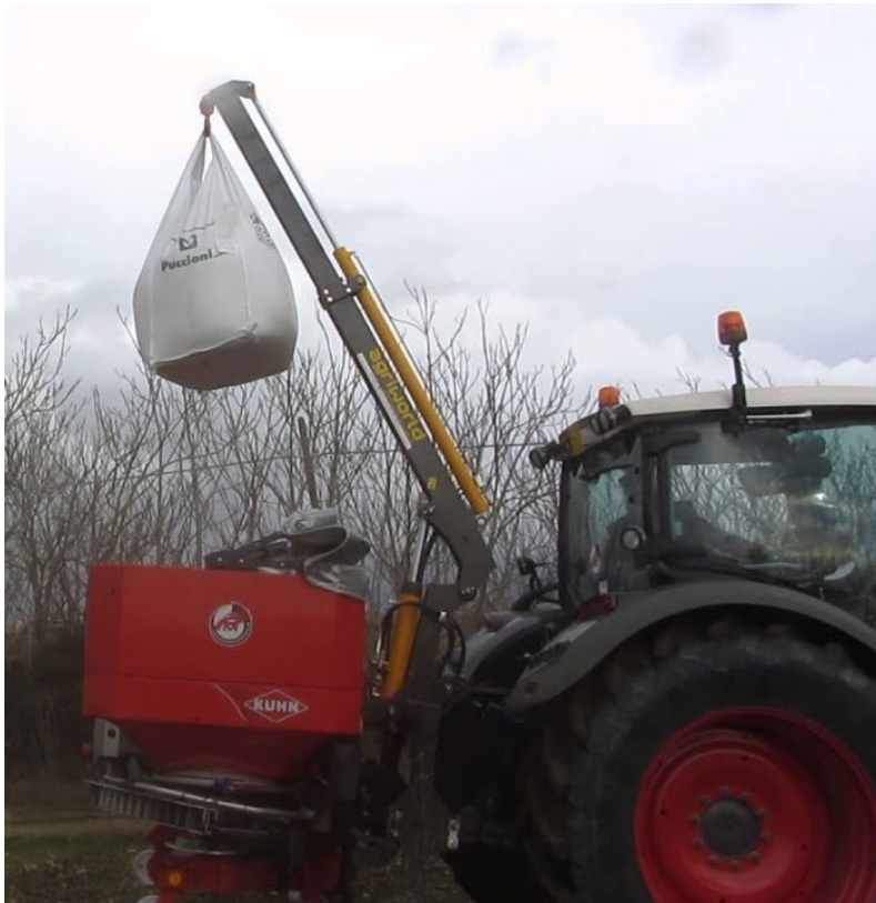
Sollevatore idraulico intercambiabile a braccio fisso abbinato ad uno spandiconcime
